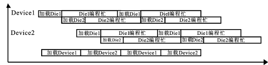
图 13 NAND FLASH 片内流水线设计
